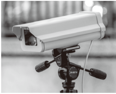
街頭に設置されるナンバープレート自動読取カメラ
